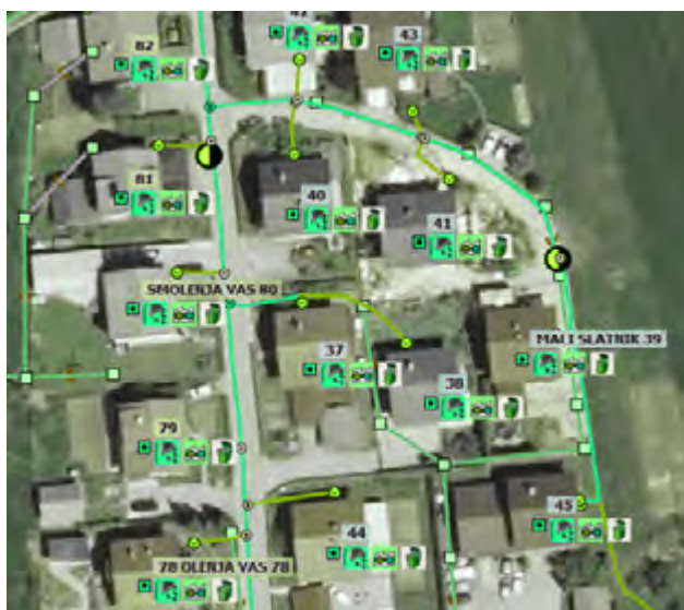
Slika 3: Prikaz odjemnih mest s storitvami v prostoru in javno omrežje vodovoda ter kanalizacije
